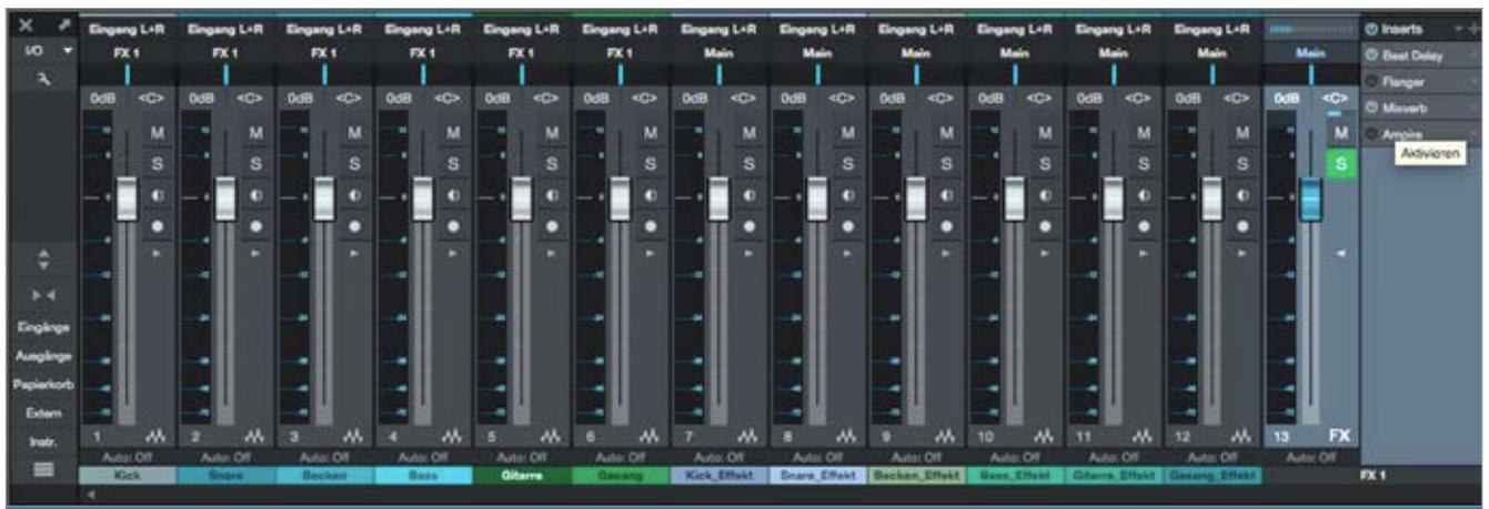
Beispielhafte Signalführung in Presonus Studio One: Die Effekte werden in den Insert geladen und können von jeder Spur angesteuert werden. Im einfachsten Fall beschränkt sich die Tätigkeit auf das Aktivieren der Effekte durch den Bypass-Knopf. Für jedes Instrument können die Effekteinstellungen vorab oder während der Aufnahme verändert werden.
