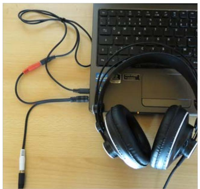
Signalführung mit Y-Kabel
